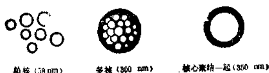
图 8-16 微胶囊的壁厚与式样之间的关系 (图中壁厚为推算值)
